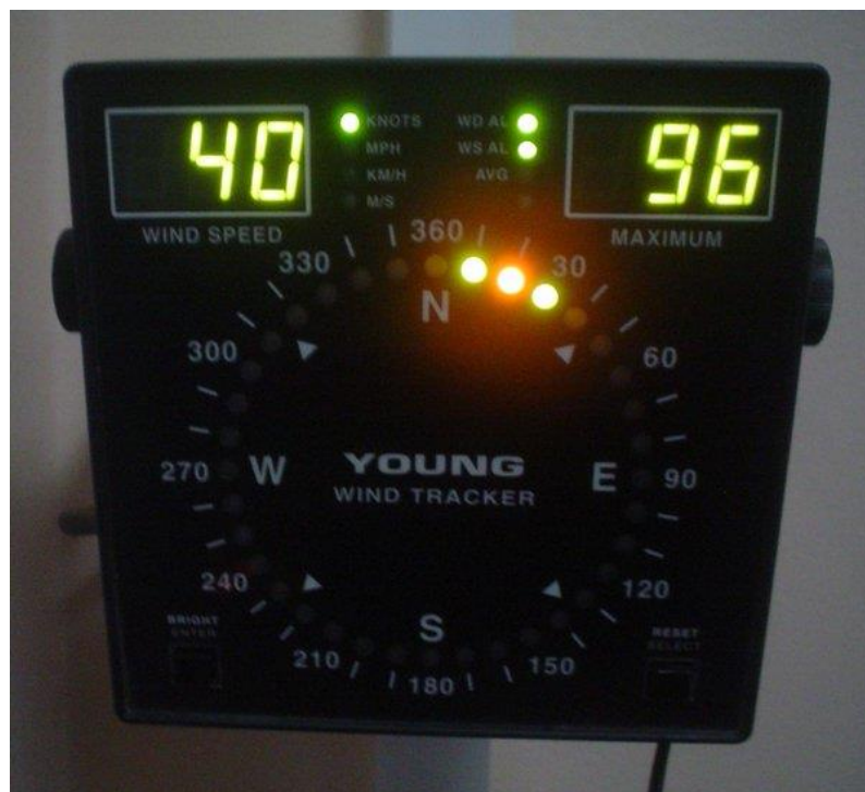
Figura 7. Imagen muestra display de anemómetro de Faro Panul, en San Antonio, a las 03:20 Hora Local, del sábado 8 de agosto de 2015, que registra viento promedio de dirección Norte/Noreste de 40 nudos (74 Kms/hora), una racha de 96 nudos (177 Kms/hora).
